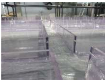
Modélisation expérimentale d'une inondation dans un réseau de rues (thèse de Mejia 2022)
